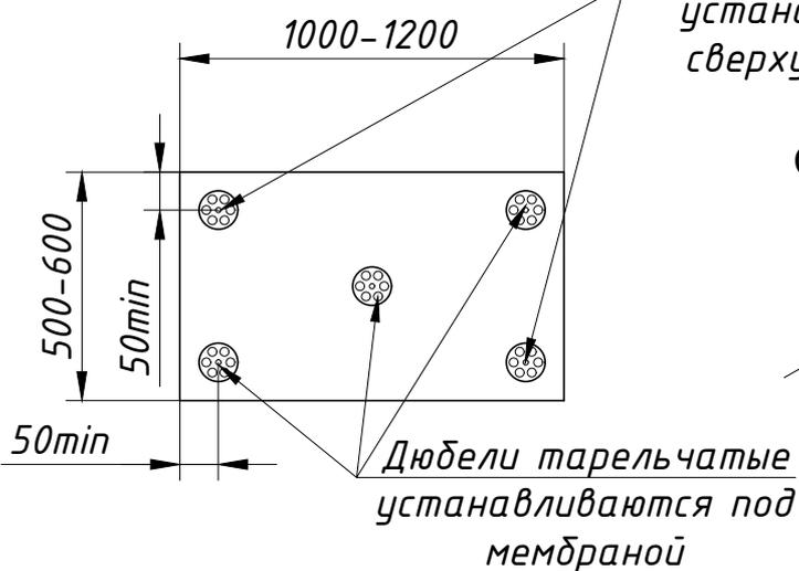
Схема крепления двухслойного утеплителя на углу здания
